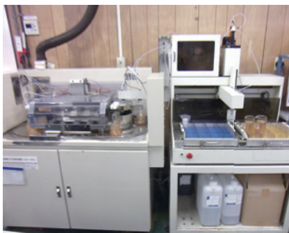
自動COD測定装置 水質の指標となる水中の有機物量を測定する装置です。
