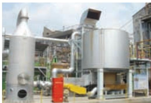
工場排ガスの臭気対策(脱臭炉)
